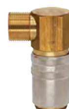
ESHG A-90 Enchufe rosca macho 90° (interior cono DIN 3863)
