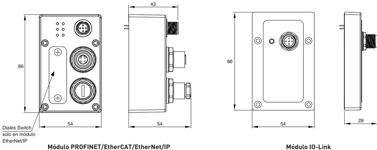
Note: A excepción de las medidas del módulo de comunicación, las dimensiones de los terminales de válvulas ESV-LK y ESV-PN/EC son iguales.
