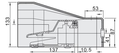
**F522C-08** Pedal metálico función 5/2, rosca 1/4, con carcasa protectora.
