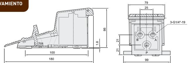
**F522C-08L** Pedal metálico función 5/2, rosca 1/4, con enclavamiento y carcasa protectora.
