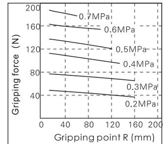
Se recomienda aplicar un margen de seguridad a la Fuerza de agarre requerida (asegurar sujeción en movimiento, etc...).
