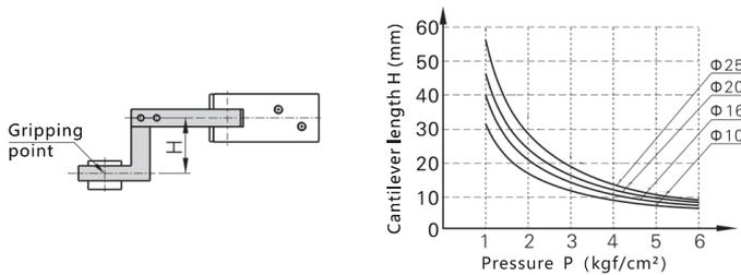
La pieza sujeta debe estar dentro de los puntos de rango de sujeción (H) para la presión indicada en la siguiente tabla. Si la pieza se encuentra fuera de los rangos de sujeción/presión podría causar daños o mal funcionamiento de la pinza.
