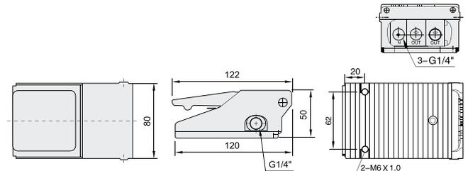
**F522-08L** Pedal metálico función 5/2, rosca 1/4, con enclavamiento.
