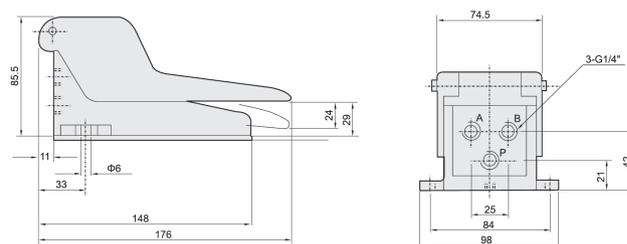
**F522-08L** Pedal metálico función 5/2, rosca 1/4, con enclavamiento.
