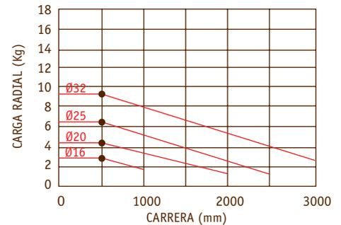
Cuando el cilindro se instala horizontalmente, la carga radial no puede exceder del valor indicado en la tabla.
