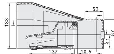
**F522C-08** Pedal metálico función 5/2, rosca 1/4, con carcasa protectora.
