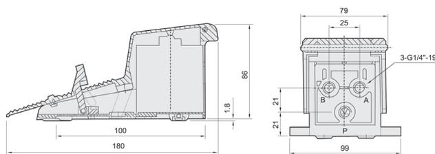
**F522C-08L** Pedal metálico función 5/2, rosca 1/4, con enclavamiento y carcasa protectora.
