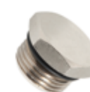
AVJ Tapón hexagonal hueco Rosca Macho cilíndrica BSPP junta NBR
