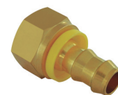
EBPF-M Rosca hembra giratoria Métrica, cono 24° con junta..
