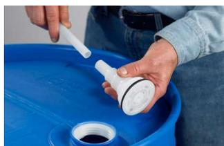
Introducir el DIP-TUBE en el agujero del DRUM INSERT
