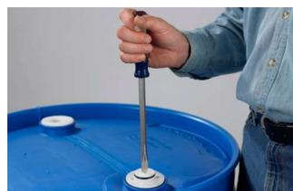
Fijarlo fuertemente mediante una llave o destornillador.
