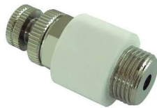
SRSA Cuerpo en latón niquelado. Silenciador polietileno sinterizado. Tornillo regulable y bloqueable. Rosca cilíndrica.
